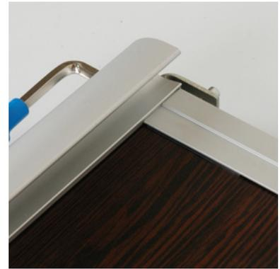
8) На корпус шкафа внизу и вверху установить направляющий профиль для распашной двери, предварительно установив в паз направляющего профиля пластиковую ответную часть петли. Далее установить дверь, произвести регулировку по высоте проема. Для регулировки двери по ширине необходимо ослабить фиксирующий винт в пластиковой ответной части петли, отрегулировать дверь по ширине относительно проема и затянуть фиксирующий винт ответной планки.
