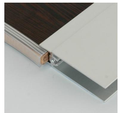
7) Далее на собранные вставки последовательно набиваются профили-ручки. Перед установкой второй ручки необходимо закрепить первую при помощи сборочных саморезов и установить верхние ролики в зависимости от выбранного типа профиля. Окончательно соединить профили-ручки с горизонтальными профилями при помощи саморезов и установить нижние ролики.
